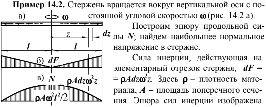
Рис. 14.2 Продольная сила N = \int_z^l dF = \int_z^l \rho A z \omega^2 dz = \rho A \omega^2 (l^2 - z^2)/2 . Эпюра продольной силы показана на рис. 14.2 в. Наибольшая сила в сечении на оси вращения.
