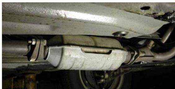
Рис. 22. Каталитический нейтрализатор отработавших газов
