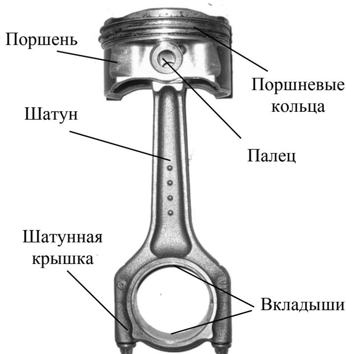
Рис. 8. Шатун в сборе с поршнем
