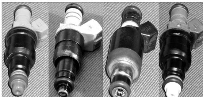
Рис. 18. Форсунки инжекторных двигателей
