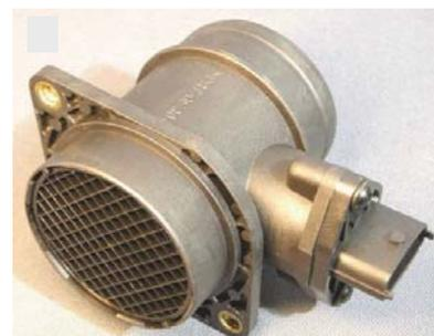
Рис. 21. Датчик массового расхода воздуха
