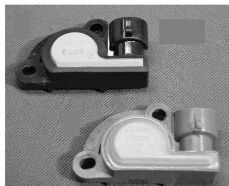
Рис. 20. Датчики положения дроссельной заслонки
