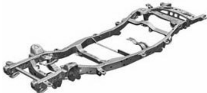
Рис. 3.9. Периферийная рама с широко расставленными в центральной части лонжеронами
