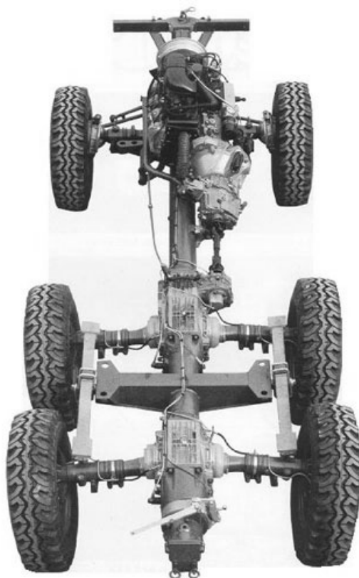
Рис. 3.10. Хребтовая рама грузовика «Татра»
