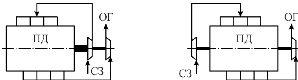
Рис. 3. Схемы способов наддува с механической связью компрессора и турбины с поршневой частью комбинированного двигателя
