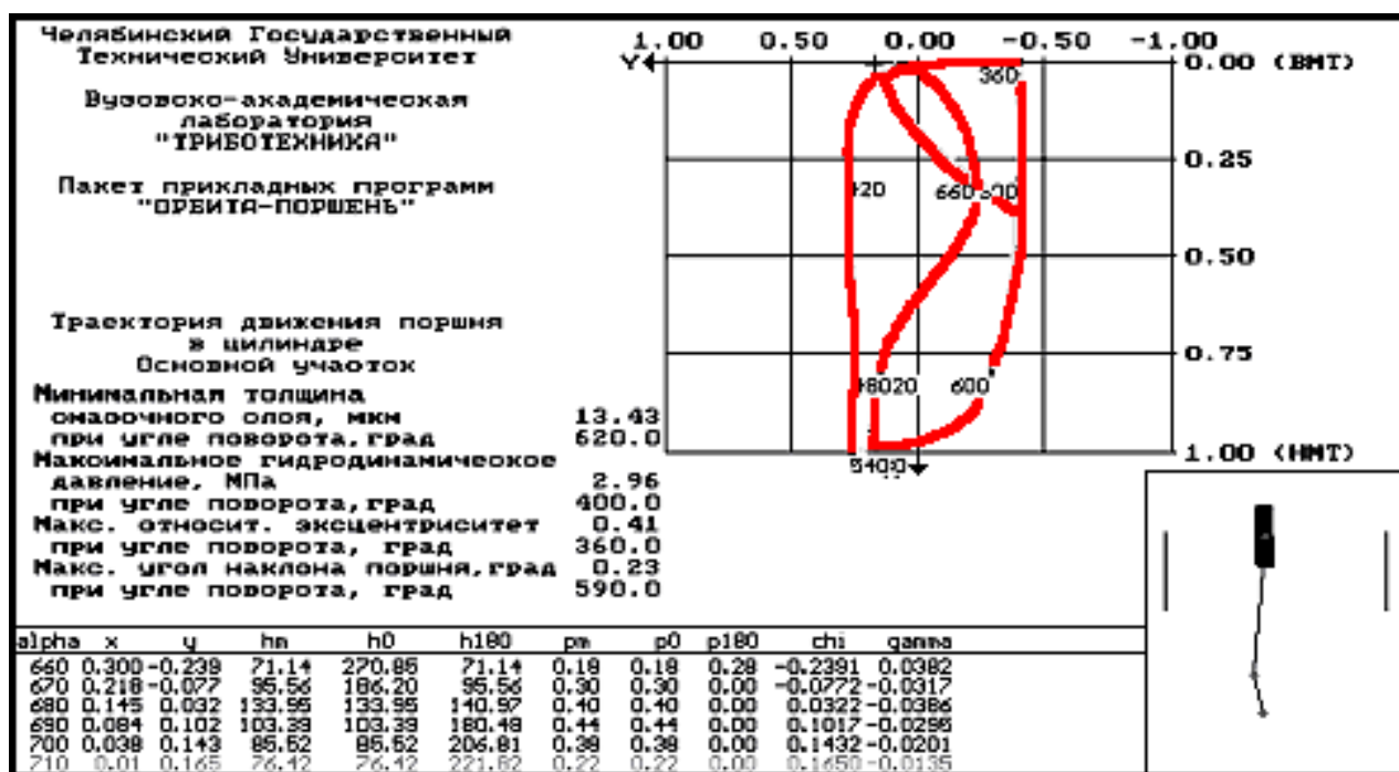
Рис. 3.4. Вид экрана при отображении полной информации о ходе расчетов при варианте построения траектории относительно минимального зазора
