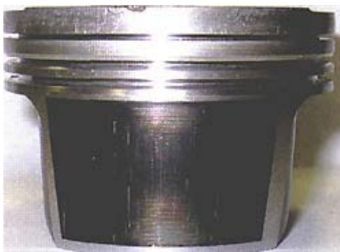
Рис. 1.4. Поршень с антифрикционным покрытием
