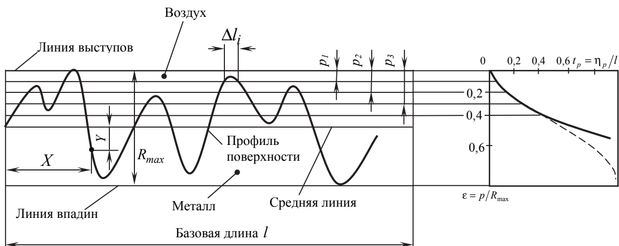
Рис. 1.1. Построение опорной кривой по профилограмме
